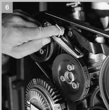
CONTI® BTT Hz (Belt Tension Tester): Medidor de tensão de correias Electronic alternative for measuring the tension of multiple V-ribbed belts: Alternativa eletrônica para medição de tensão de correias multi-V.
