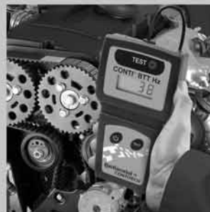
CONTI® BTT Hz (Belt Tension Tester): Medidor de tensão de correias Electronic alternative for measuring the tension of multiple V-ribbed belts: Alternativa eletrônica para medição de tensão de correias multi-V.
